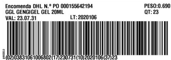
Figura 9. Exemplo das correções realizadas na etiqueta de caixa por um dos fornecedores em âmbito: Erro na estrutura da linha de código do GS1-128 (presença de espaços codificados – assinalados na imagem)
