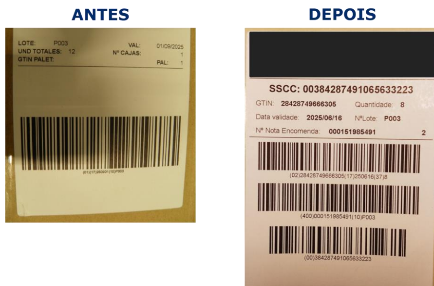
Figura 6. Exemplo das correções realizadas na etiqueta de palete por um dos fornecedores em âmbito: Inclusão de Identificadores de Aplicação
