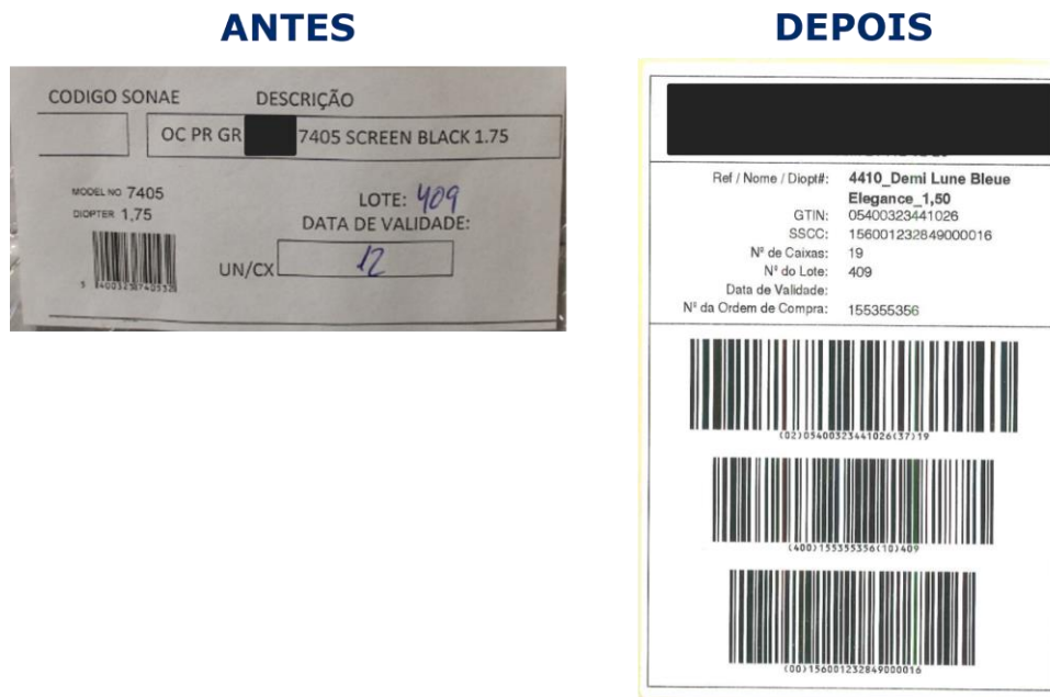
Figura 7. Exemplo das correções realizadas na etiqueta de palete por um dos fornecedores em âmbito: Alteração de EAN-13 para GS1-128
